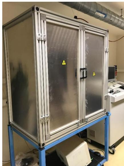
Figure 12 : Protection définitive du banc de soudure
